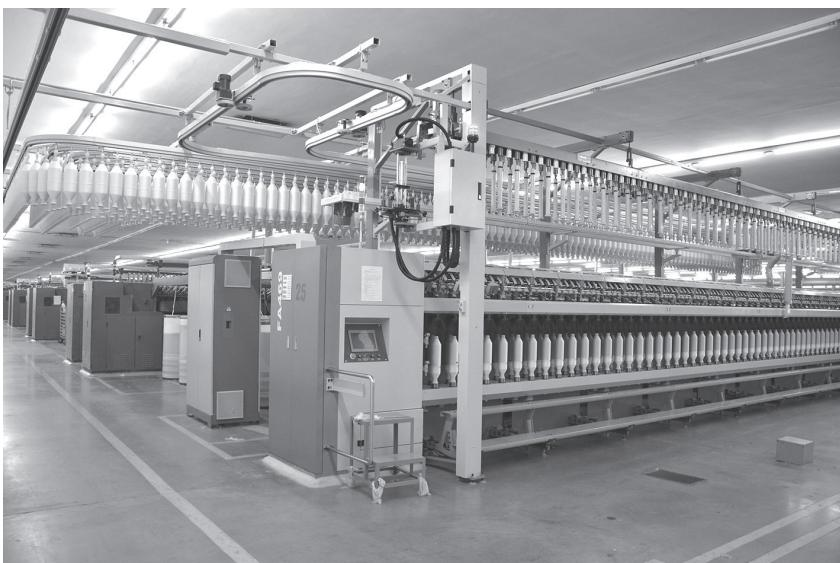
的纺纱车间，成排的纺织女工不见了，有的只是三五工人巡视和简单操作。无锡一棉党委书记、董事长周晔珺透露：“新一代的智能车间里，每一个纱锭都会通过传感器联网，系统可以实时监测到生产线上每个纱锭的情况。”
